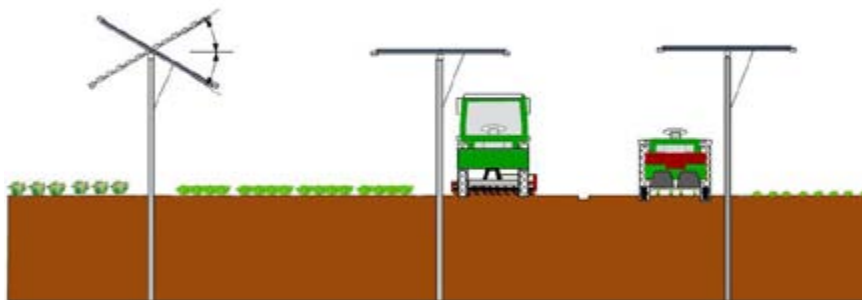
Abb. 1: Schematischer Aufbau der geplanten Solaranlage zur Mehrfachnutzung
